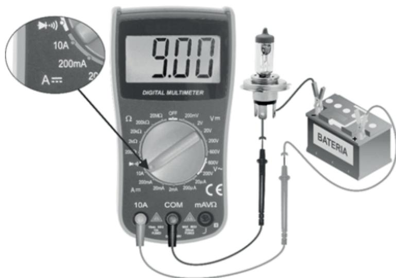
NUNCA conecte as pontas de prova em paralelo com o circuito estando nestas escalas.
