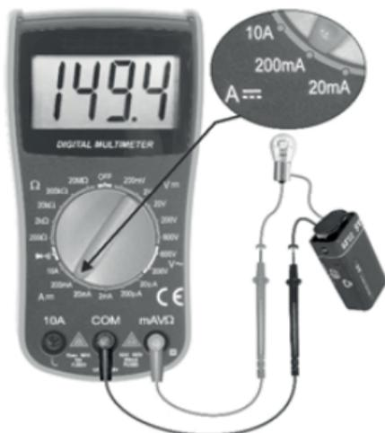
NUNCA conecte as pontas de prova em paralelo com o circuito estando nestas escalas.
