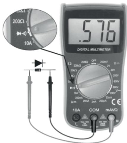
Quando o diodo estiver bom, um valor entre 0,23 e 0,75 V (dependendo do tipo do diodo) será indicado no display.
