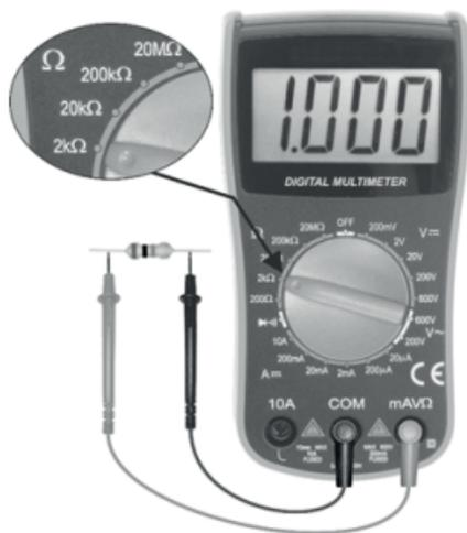
Caso seja exibido à esquerda do visor o número "1.", é porque o nível de resistência é alto demais para esta escala; escolha uma escala superior.
