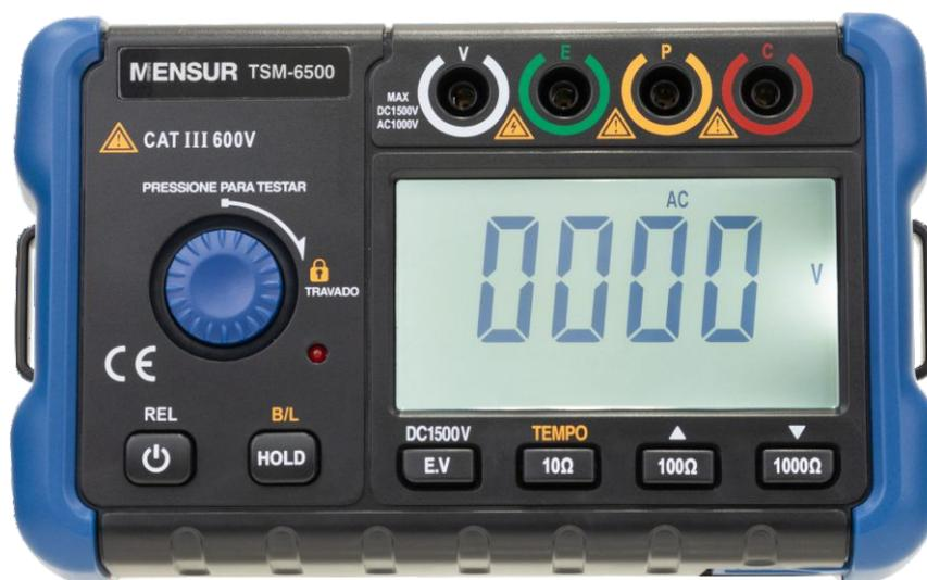
O TSM-6500 foi projetado para medir a resistência do solo, essencial para garantir a segurança e eficácia dos sistemas de aterramento elétrico. Ele permite avaliar a capacidade do solo em dissipar corrente e a qualidade da ligação à terra, crucial para proteger pessoas e equipamentos de falhas e descargas elétricas.
